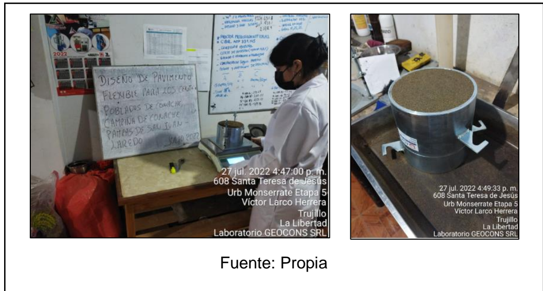
Figura 25. Ensayo de Proctor modificado (Registrando el peso de la muestra húmeda más el peso del molde).
