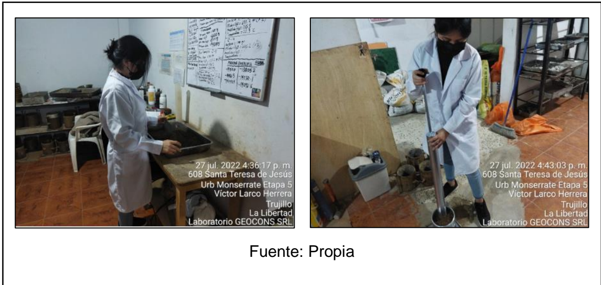
Figura 24. Ensayo de Proctor modificado (Saturando la muestra para su ensayo Proctor Modificado).
