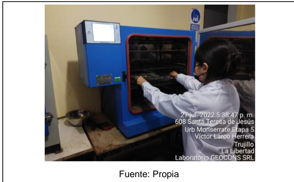
Figura 22. Ensayo de contenido de humedad (Ingresando las muestras en el horno).
