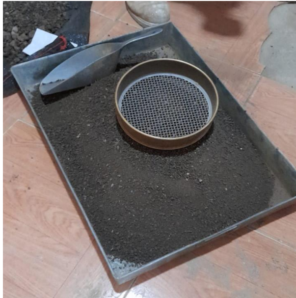
Figura 32. Tamizado de muestra para ensayo de proctor modificado
