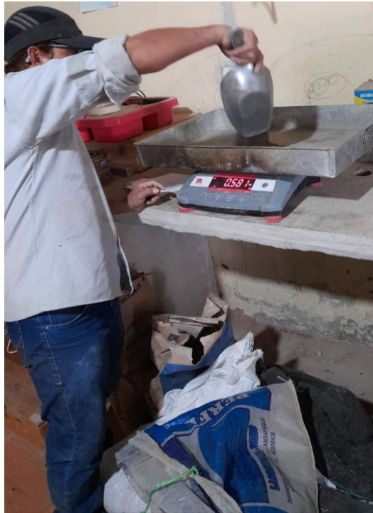
Figura 28. Peso de muestra para ensayo granulométrico
