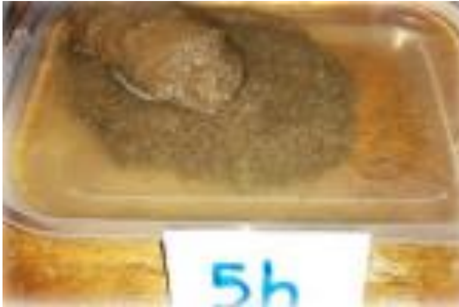
Figura 34. Ensayo de ascenso capilar del material natural – Probeta 01
