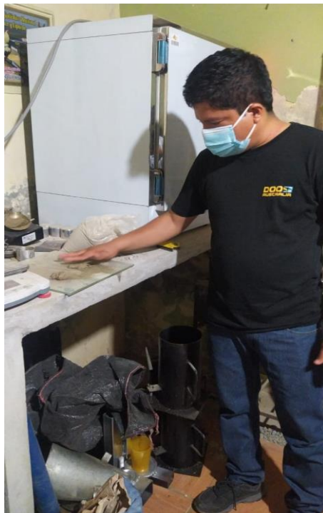
Figura 31. Elaboración de barras cilíndricas sobre superficie de vidrio
