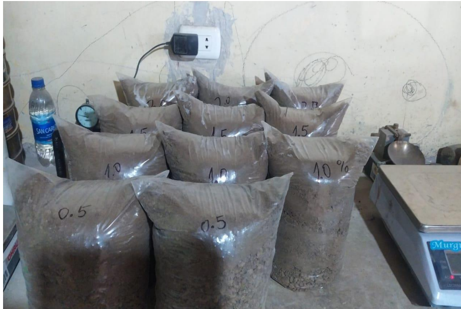
Figura 42. Muestra C01 estabilizada con 04 dosificaciones diferentes
