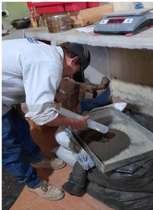
Figura 33. Adición de agua destilada para ensayo de proctor modificado
