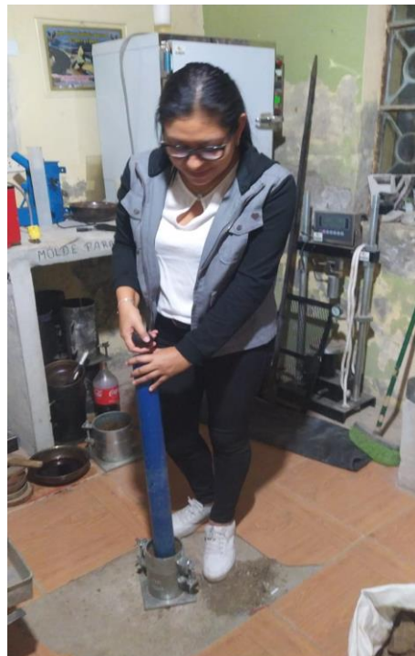
Figura 45. Ensayo de proctor modificado de la muestra estabilizada
