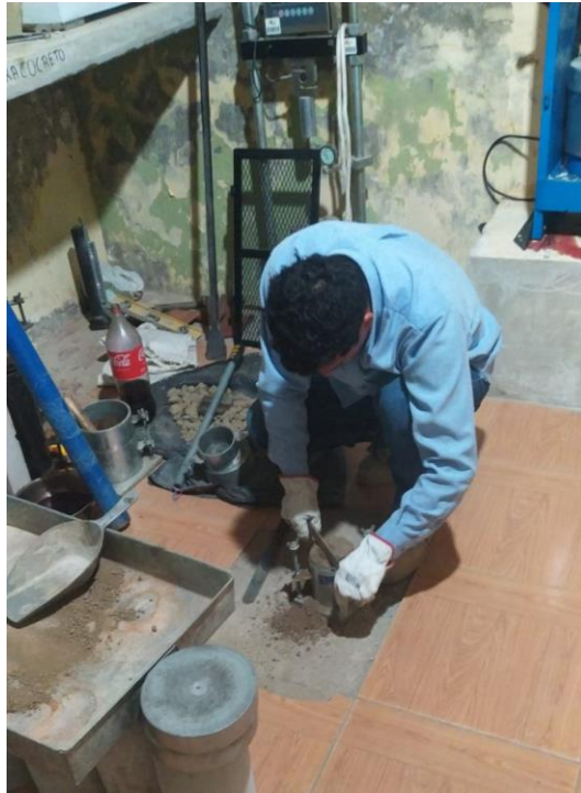
Figura 44. Enrasado de material compactado de la muestra estabilizada
