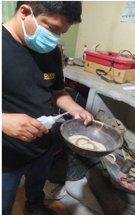
Figura 30. Adición de agua destilada para elaboración de límite plástico
