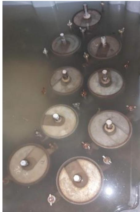
Figura 47. Ensayo de CBR de muestra de suelo con Sistema Consolid (Inmersión de moldes)
