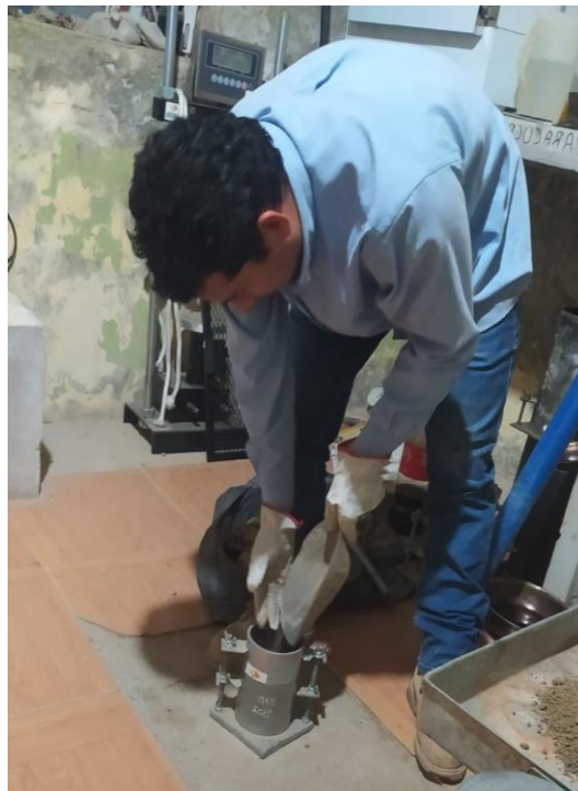
Figura 43. Ensayo de proctor modificado de la muestra estabilizada
