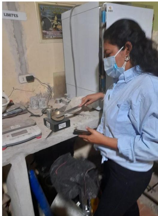
Figura 29. Realización de ensayo de Límite líquido (copa de Casagrande)
