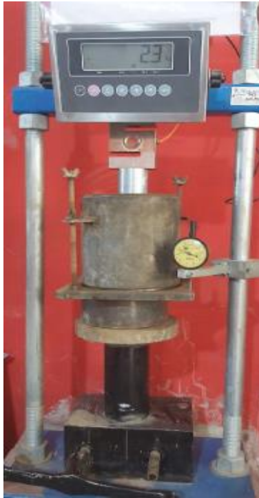
Figura 48. Ensayo de CBR con Sistema Consolid (Determinación de deformaciones)
