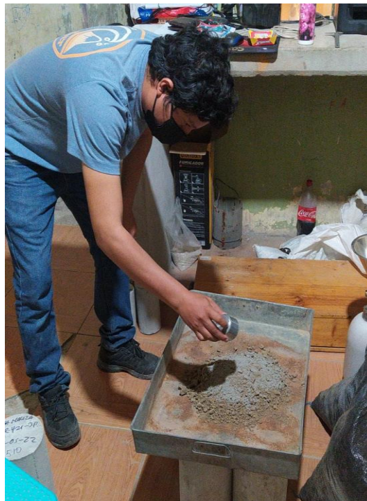
Figura 41. Adición de formulación sólida (SOLIDRY) para estabilizar muestras
