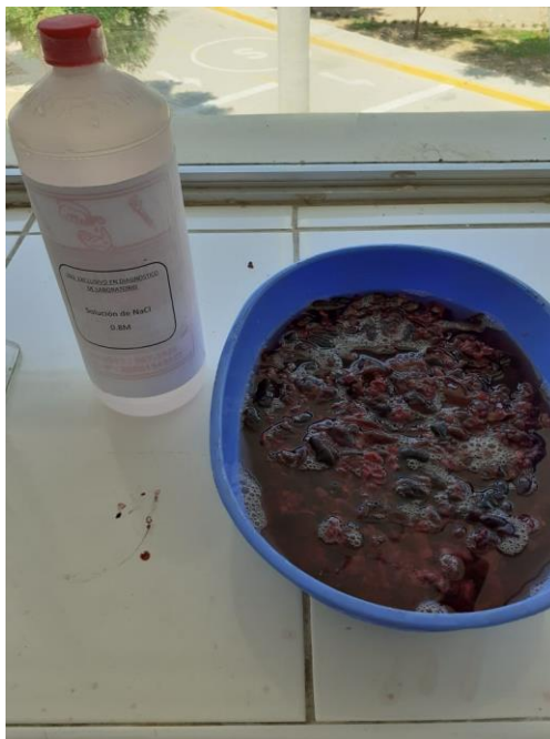
Figura 23 Piel de papa reposando durante 15min en NaCl
