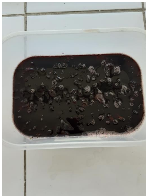
Figura 19 Piel de pota reposando en NaOH por 15min
