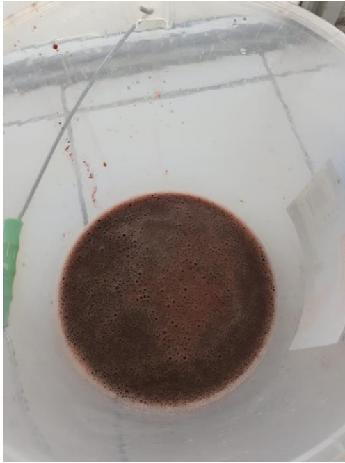
Figura 20 Licor obtenido de la filtración de la piel de pota y el NaOH
