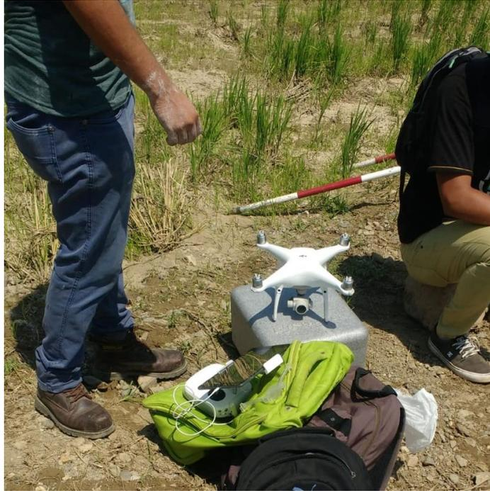
**Figura 7. Drone empleado para el levantamiento topográfico.**
