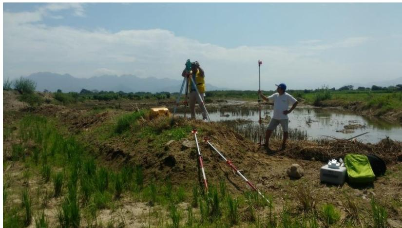
**Figura 8. Estación Total utilizado para el levantamiento topográfico.**
