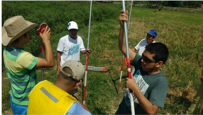
**Figura 9. Prismas utilizados en puntos estratégicos para una mejor visualización con la Estación Total**
