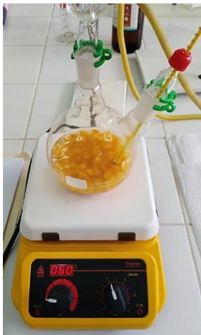
Imagen 4. Extracción por destilación a reflujo de Physalis peruviana L.
