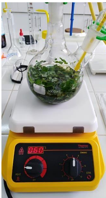
Imagen 11. Extracción por destilación a reflujo de Eucalyptus globulus Labill
