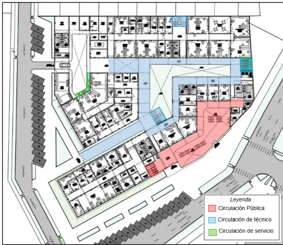
FIGURA N° 55: Circulaciones primer nivel
