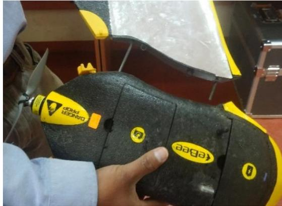
Una vez ya acoplado el servo con las alas se debe de empujar suavemente para que los acoples se unan a drone
