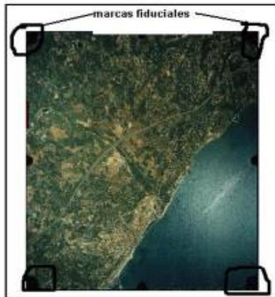
FIG. 49: Señalización de marcas fiduciales de una toma fotogramétrica.
