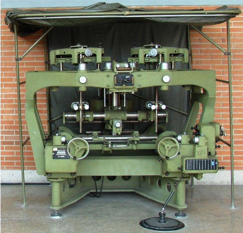
FIG. 44: Una de las primeras máquinas alemanas Wild para el uso fotogramétrico.
