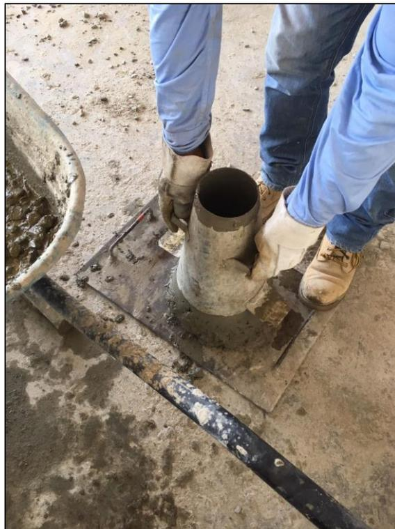
**Figura N° 25: Ensayo de Asentamiento (Slump)**
