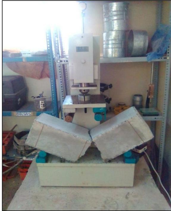
**Figura N° 20: Ruptura de Viga en Ensayo de Resistencia a la Flexión**
