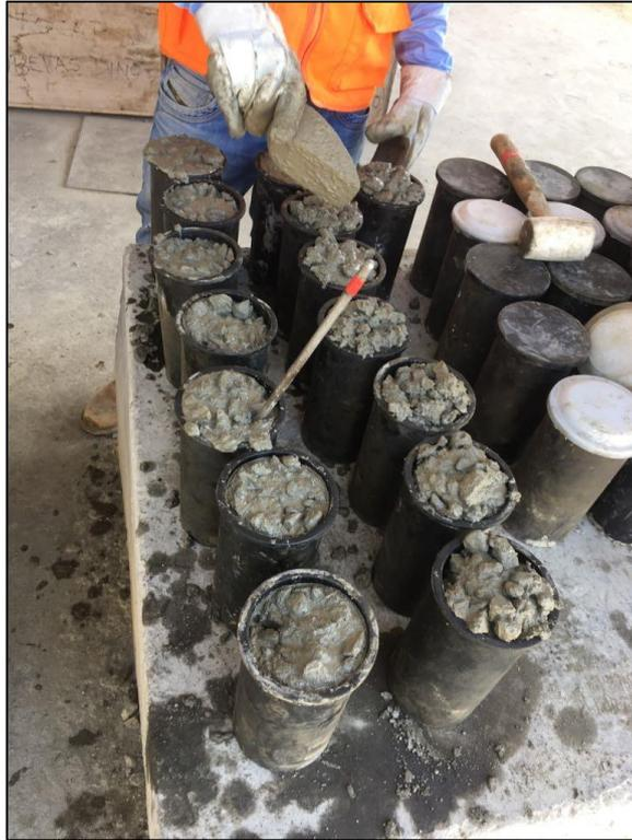
**Figura N° 22: Elaboración de Probetas para Ensayo de Resistencia a la Compresión**
