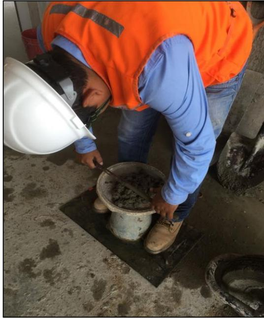
Figura Nº 3: Ensayo de slump.
