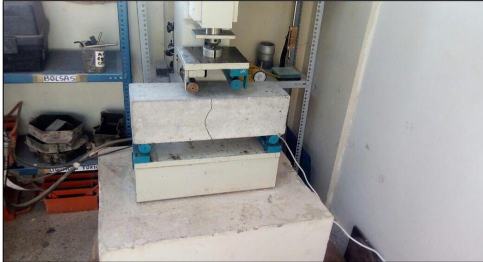
**Figura Nº 14: Ensayo de resistencia a la Flexión.**
