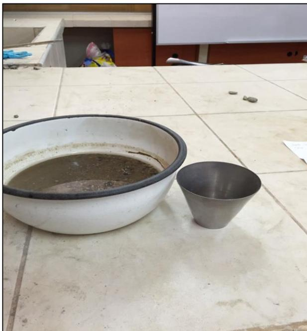
**Figura Nº 18: Muestras Para Ensayo de Contenido de Humedad**
