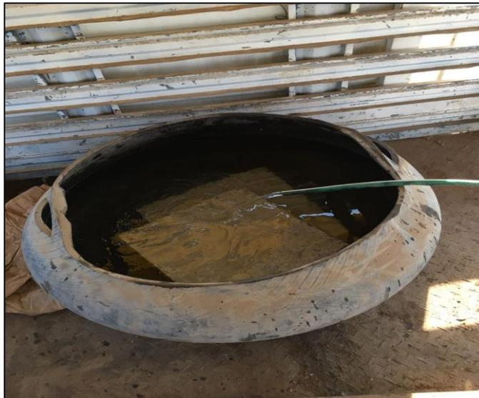
**Figura N° 16: Curado de los Bloques de Concreto para Ensayo de Permeabilidad.**
