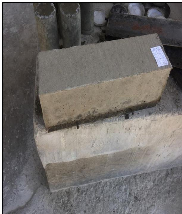
**Figura Nº 19: Viga de Concreto para Ensayo de Resistencia a la Flexión**
