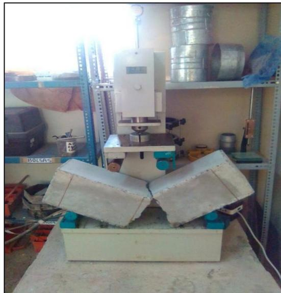
**Figura Nº 15: Ensayo de Resistencia a la Flexión en el Momento de Ruptura.**
