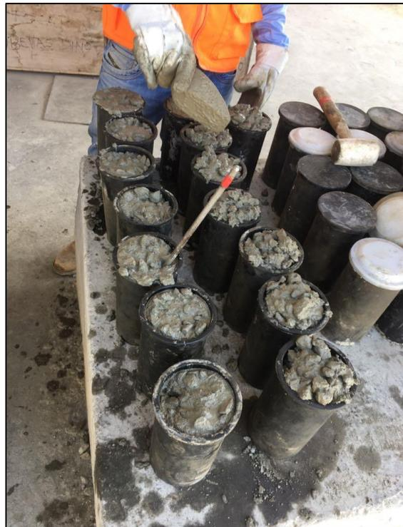
**Figura Nº 10: Proceso de muestreo de probetas.**
