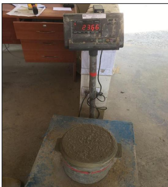
Figura N° 5: Muestra de concreto en el recipiente.
