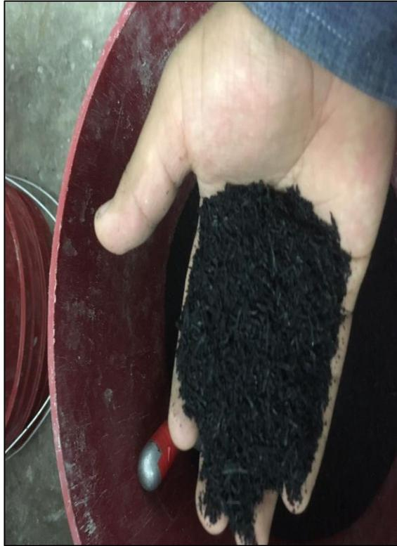
**Figura N° 24: Muestra de Elastómero Termoplástico Triturado**
