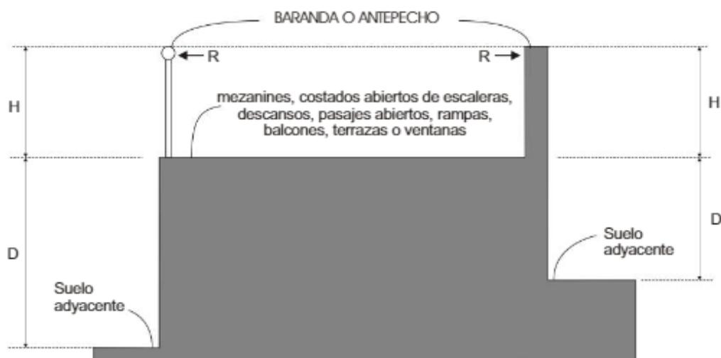
R: resistencia a sobrecarga horizontal > 50 kg/m
