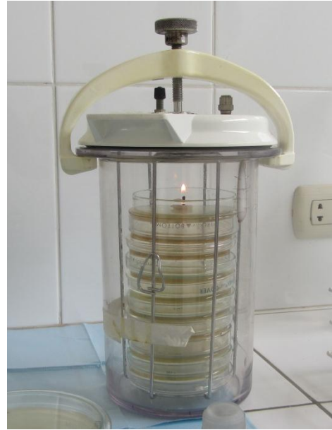
Incubación de las placas petri en posición invertida a 37°C por 24 horas.
