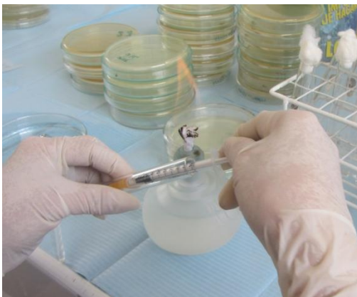
Adición de 0.1 ml del hipoclorito de sodio a 2.5% en sus diferentes temperaturas en su correspondiente placa petri contenidos en agar soya tripticaasa.
