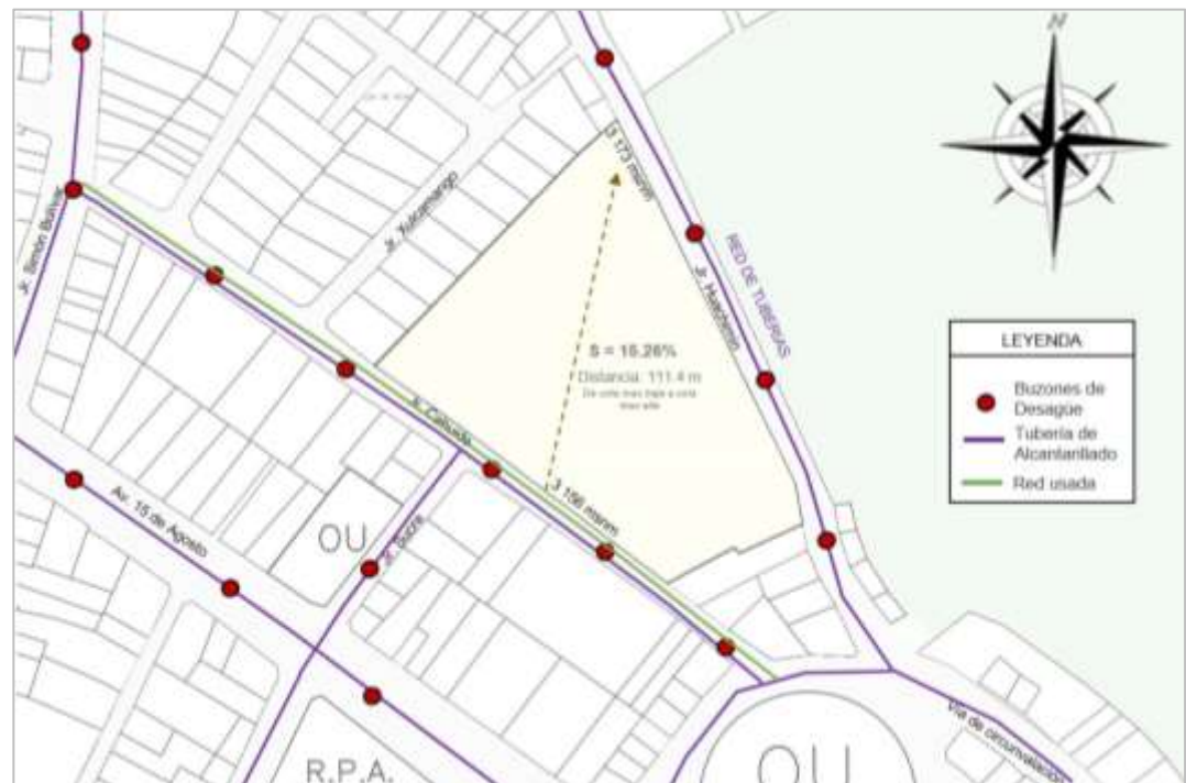
Imagen N°32: Red de tuberías de desagüe
