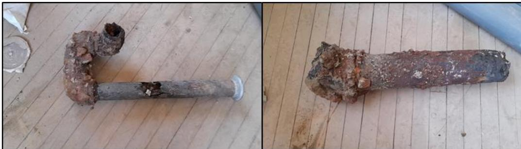
Presencia de corrosión en las tuberías de las instalaciones de desagüe.
