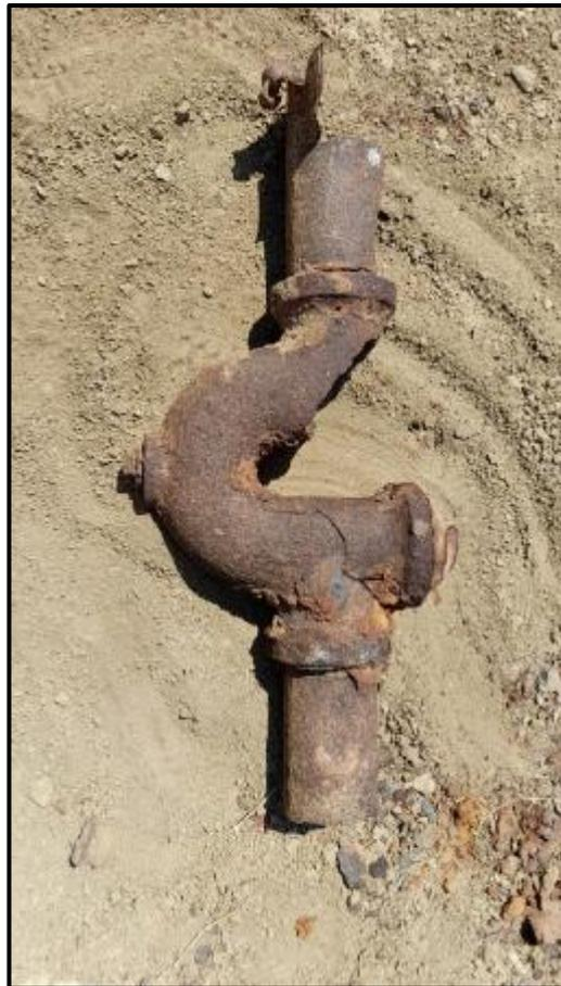
Tuberías deterioradas con presencia de corrosión.
