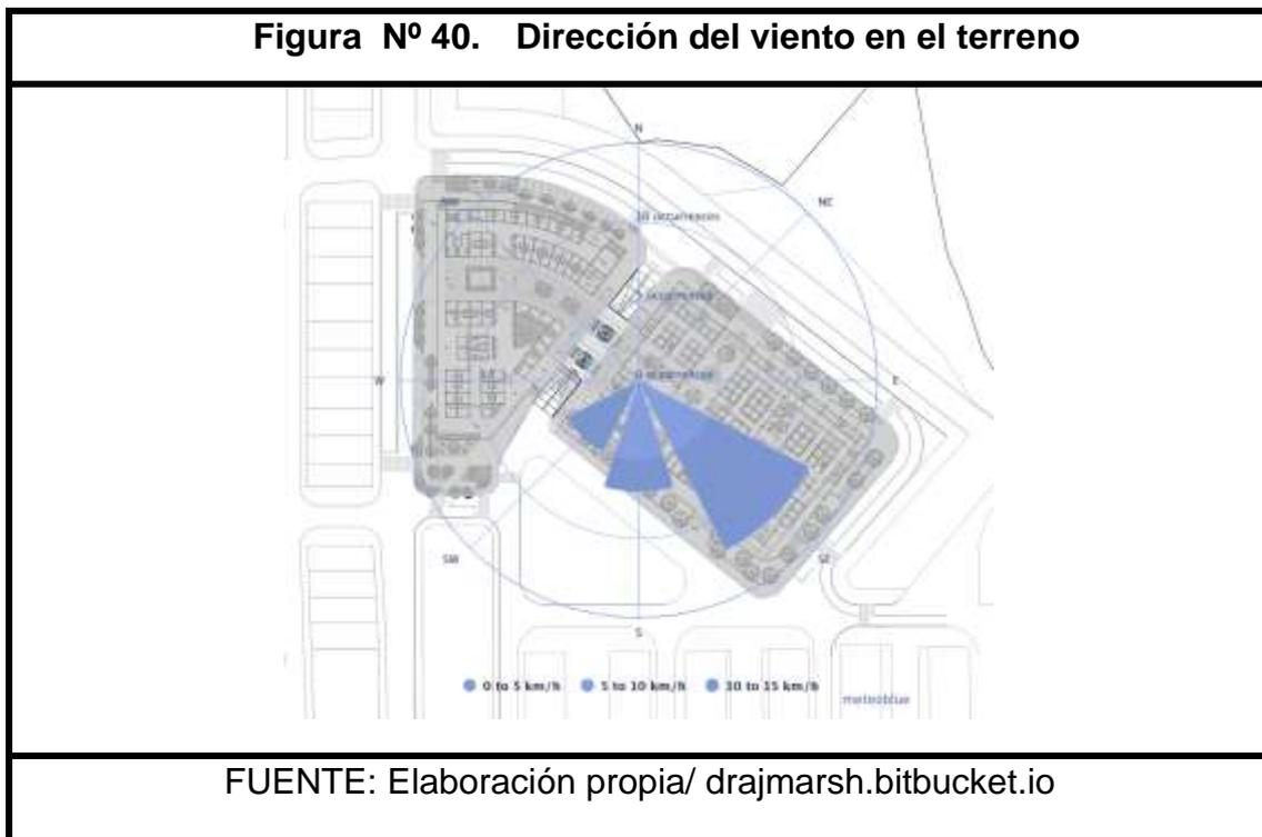
El viento ingresaría por los parasoles seguidamente por ventanas que van ir en el muro cortina ya sean corredizas o pivotantes, se planteado una altura entre los 4 y 4.50 m para que el viento pase sobre los puestos y salga por los diversos patios, el aire caliente debido a su densidad haciendo por ello esto permitiría circular con mayor facilidad el viento.
