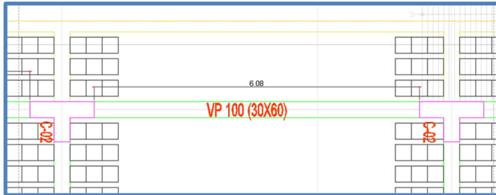
FIGURA N° 68: Cálculo de peralte de la viga de la luz mayor del plano
