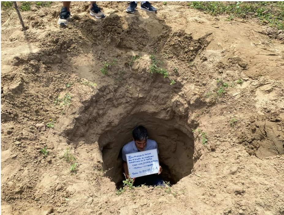
Realización de la Calicata 04
