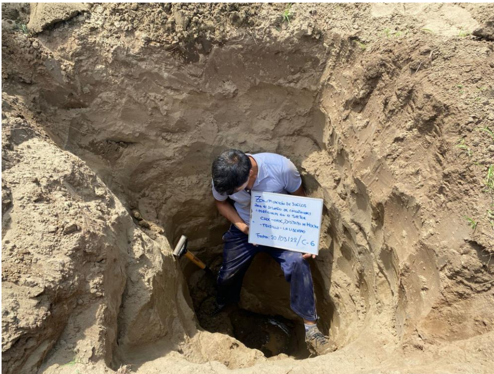
Realización de la Calicata 06
